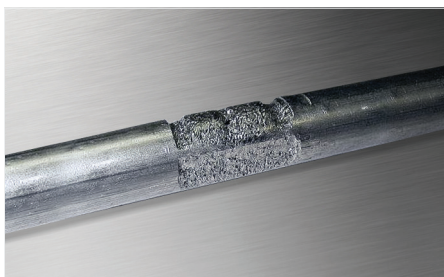
Corrosión por grietas debajo de un cuerpo de abrazadera común
