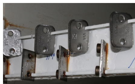
Pruebas en la cámara de pulverizado de niebla salina con accesorios de fijación ACT (arriba en la imagen) en comparación con las piezas convencionales de acero fino V4A (abajo en la imagen)
