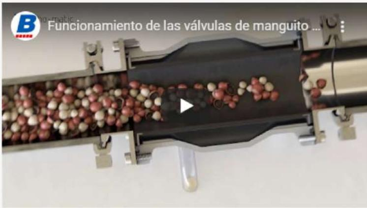
Con una presión de control aprox. 2,5 bar superior a la presión del fluido, la válvula de manguito HOmatic sella fluidos gaseosos, líquidos, pastosos o en polvo. El manguito altamente elástico rodea cualquier sólido. No se puede garantizar estanqueidad para gases si el medio de flujo contiene partículas gruesas.
