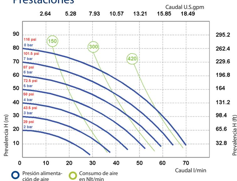
Las curvas y las prestaciones hacen referencia a bombas con aspiración sumergida y salida en boca libre, con el agua a 20°, y varían en función del material de fabricación.
