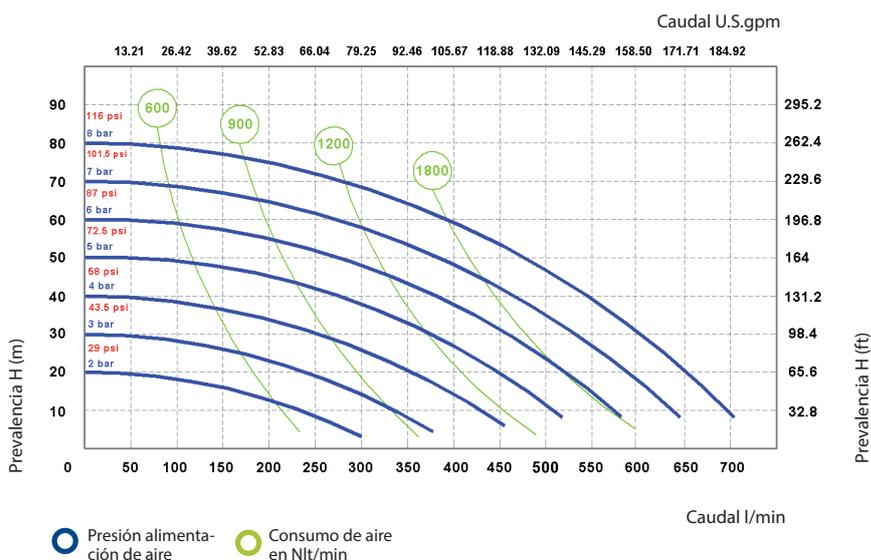
Las curvas y las prestaciones hacen referencia a bombas con aspiración sumergida y salida en boca libre, con el agua a 20°, y varían en función del material de fabricación.
