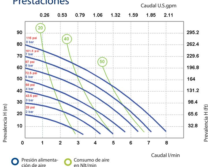
Las curvas y las prestaciones hacen referencia a bombas con aspiración sumergida y salida en boca libre, con el agua a 20°, y varían en función del material de fabricación.
