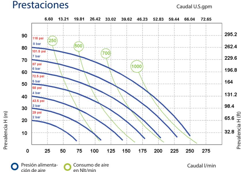
Las curvas y las prestaciones hacen referencia a bombas con aspiración sumergida y salida en boca libre, con el agua a 20°, y varían en función del material de fabricación.
