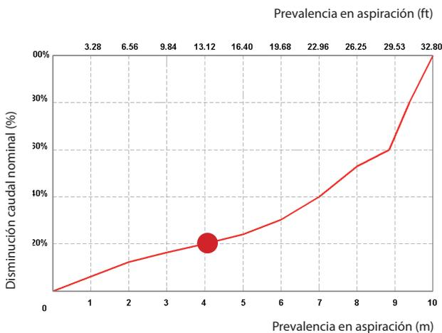
Con una altura de aspiración de 4 m, la bomba reduce su caudal en casi un 20%. Válido para bombas de 3/4" y mayores; los datos varían en función de la configuración de la bomba.
