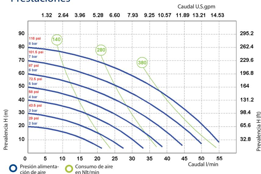
Las curvas y las prestaciones hacen referencia a bombas con aspiración sumergida y salida en boca libre, con el agua a 20°, y varían en función del material de fabricación.
