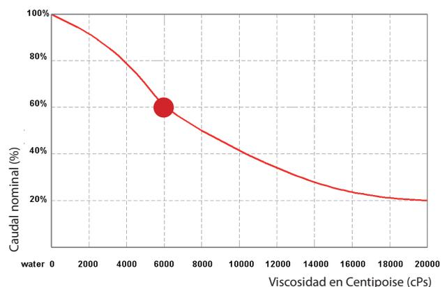
Durante el bombeo de un fluido con una viscosidad de 6000cPs la caudal de la bomba desciende al 60% de su valor nominal (100% = agua). Válido para bombas de 3/4" y mayores.
