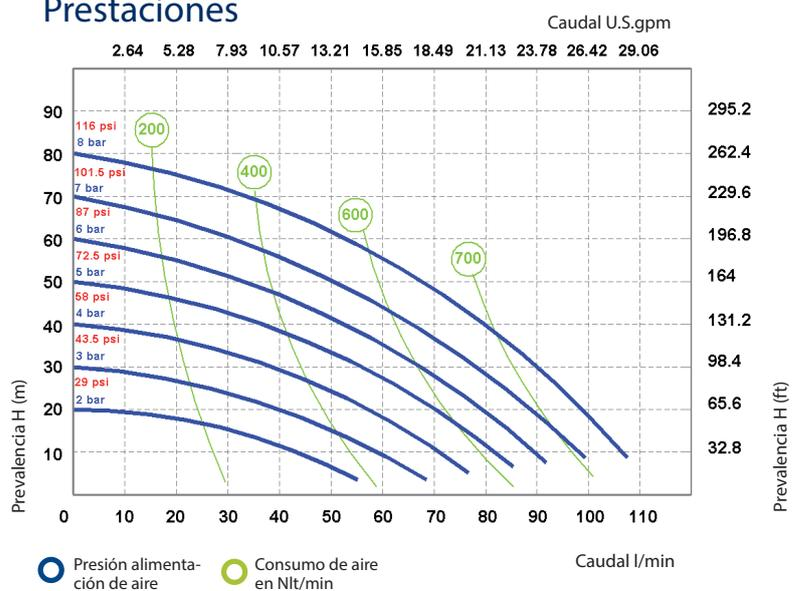
Las curvas y las prestaciones hacen referencia a bombas con aspiración sumergida y salida en boca libre, con el agua a 20°, y varían en función del material de fabricación.
