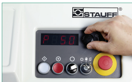
Área de manejo de la máquina de montaje con botón de manejo con función de presión y giro, así como indicación de parámetros
