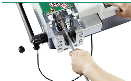
Cabezal de herramienta para el montaje de anillos cortantes con ajuste automático de presión/detección de tamaño
