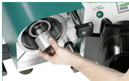
Colocación del racor de conformado con cierre de bayoneta, sin ningún tipo de herramienta
