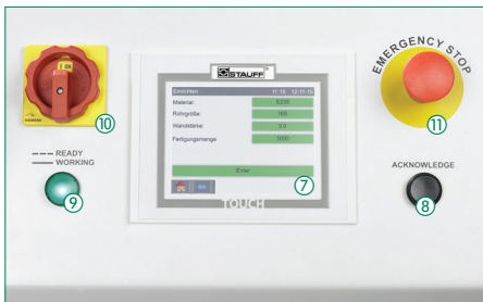
Área de manejo de la conformadora de tubos
