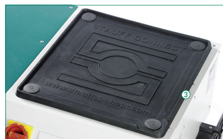
Colocación de herramienta amortiguadora de ruidos
