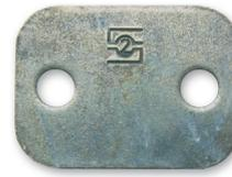
Original STAUFF Deckplatte mit Zink/Nickel-Beschichtung: Keine Anzeichen von Korrosion nach **528 Stunden** in der Salzsprühnebelkammer!
