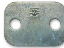
Original STAUFF Deckplatte mit Zink/Nickel-Beschichtung: Keine Anzeichen von Korrosion nach **528 Stunden** in der Salzsprühnebelkammer!
